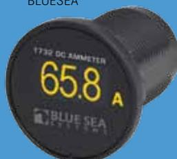
Les batteries perdent de leur capacité avec le temps, à cause du phénomène de sulfatation. Si la mesure de tension est faite alors qu'un équipement consommateur est en marche, une baisse rapide de tension est le signe de faiblesse de la batterie due à une charge insuffisante ou au fait qu'elle est usagée. L'ampèremètre sert à surveiller le courant de charge / décharge.
